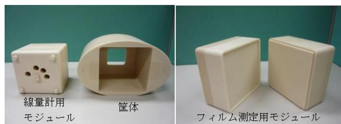
図1 IMRT用ファントム。線量計用と線量分布用（フィルム測定用）モジュールに分けられる。
